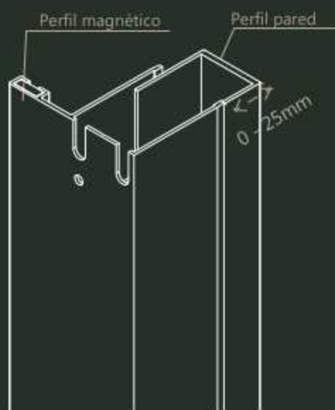
Perfil laterales expansor magnético
